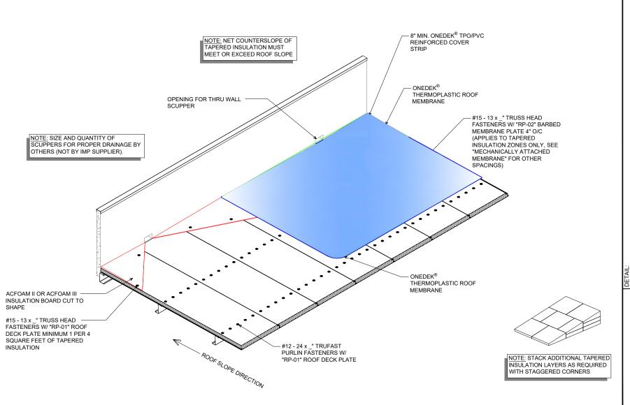
ONEDEK® TAPERED INSULATION AND SCUPPER INSTALLATION ALONG PARAPET (MECHANICALLY ATTACHED)
