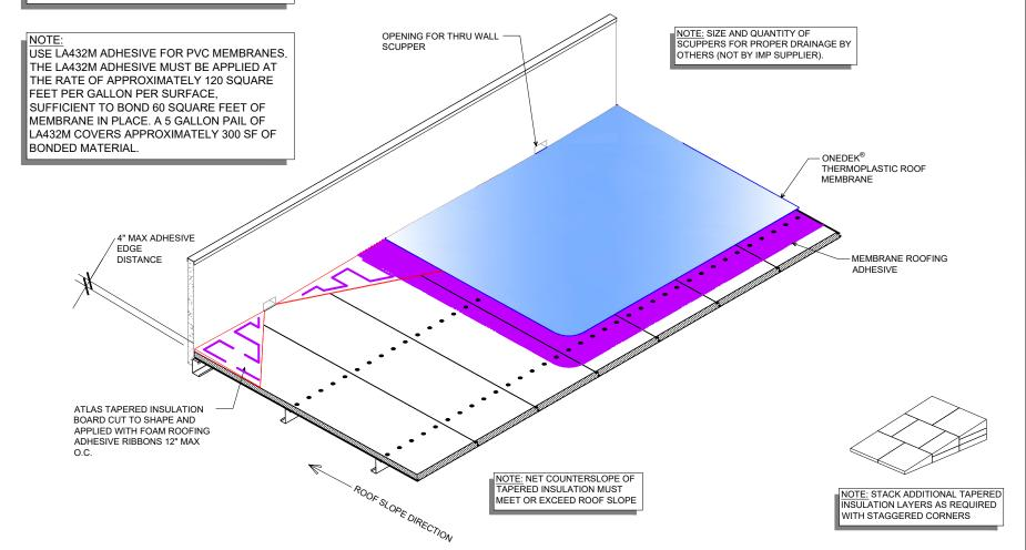
ONEDEK® TAPERED INSULATION AND SCUPPER INSTALLATION ALONG PARAPET (FULLY ADHERED)
